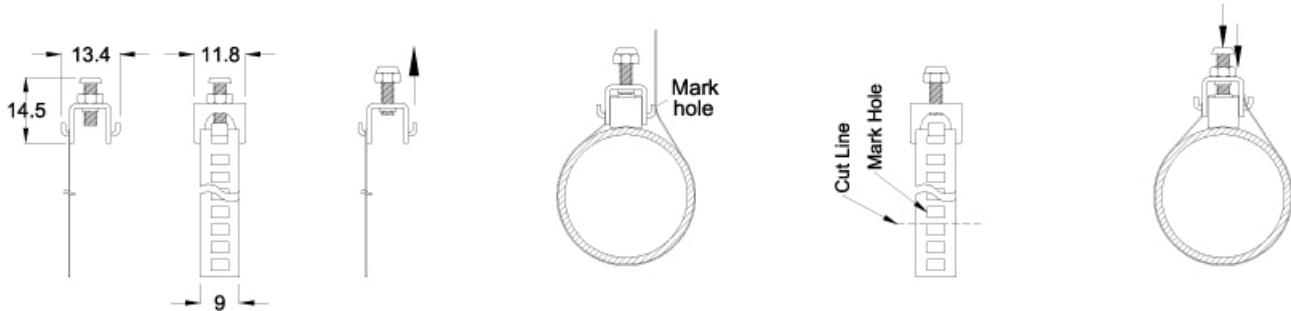
Step 1 Loosen screw & nut.
